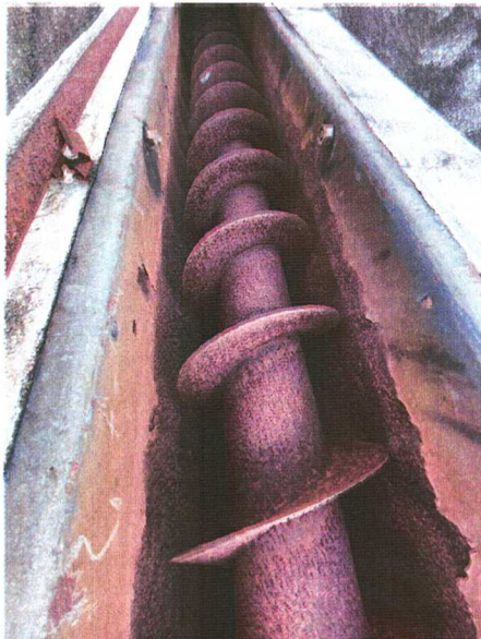
Fotos 03 e 04- Imagens das transportadoras helicoidais de areias atualmente.
